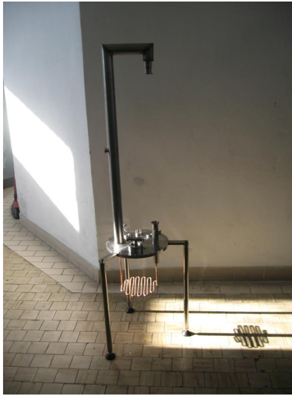
Figura 13.5 – Apparato criogenico in assenza del dewar elio e azoto.
