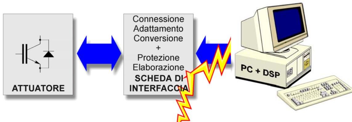
Fig. 5.16 Scheda di interfaccia dotata di capacità di elaborazione che protegge la struttura di potenza da malfunzionamenti del sistema di controllo
