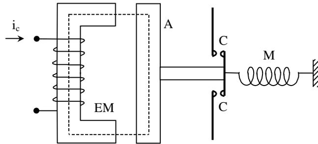
Fig. 22 – Schema di principio di un relè elettromagnetico.
