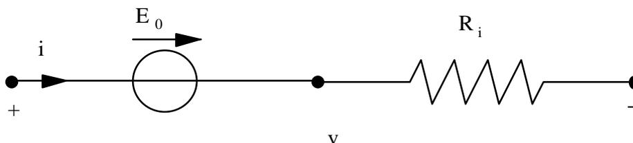
Figura 17 Modello circuitale di una batteria
