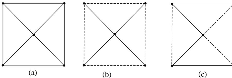
Figura 19 (a) grafo di circuito, e (b,c) due dei possibili alberi (linea continua) e coalberi (linea tratteggiata)
