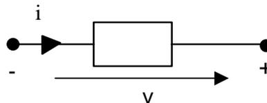
Fig. 7. Versi di riferimento per la tensione e la corrente di ramo secondo la convenzione del generatore.
