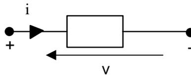
Fig. 6. Versi di riferimento per la tensione e la corrente di ramo secondo la convenzione dell'utilizzatore.
