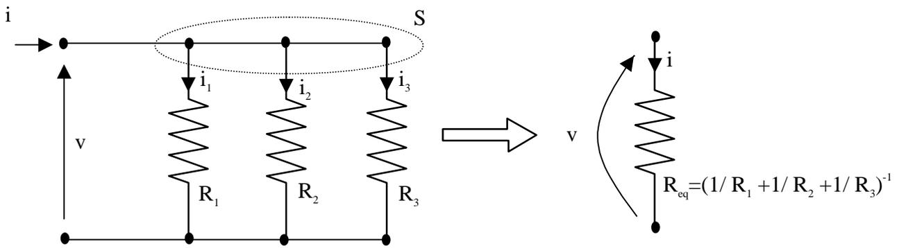
Figura 11 Resistori collegati in parallelo
