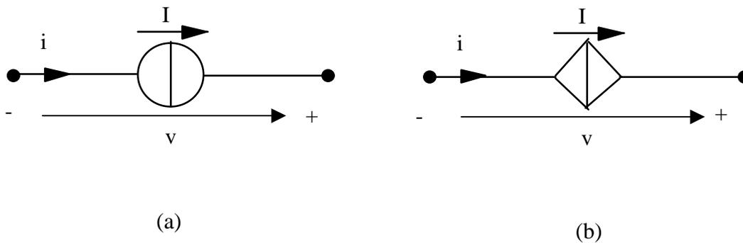
Figura 18 Generatore di corrente
