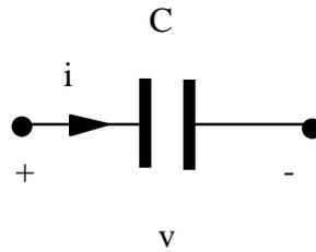
Figura 14 Condensatore
