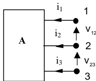
Fig. 2 Componente a tre terminali
