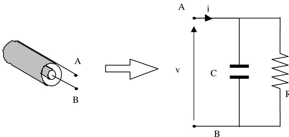
Figura 15 Condensatore cilindrico
