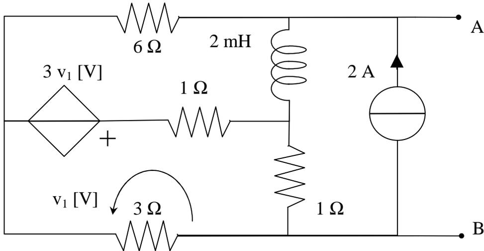
Il bipolo in figura è collegato ad un bipolo di Norton con corrente impressa sinusoidale di valore efficace 12 A e conduttanza equivalente 20 mS. Il circuito è in regime sinusoidale alla frequenza  $f = 50$  Hz. Calcolare:
