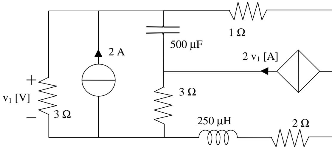
Determinare l'equivalente di Thevenin del bipolo in figura, in regime AC a frequenza 50 Hz.
