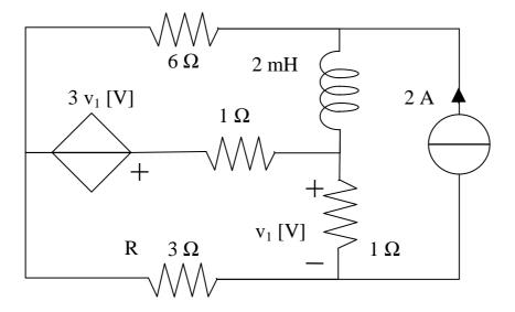
Il circuito è in regime in regime sinusoidale alla frequenza f = 50 Hz. Calcolare:
