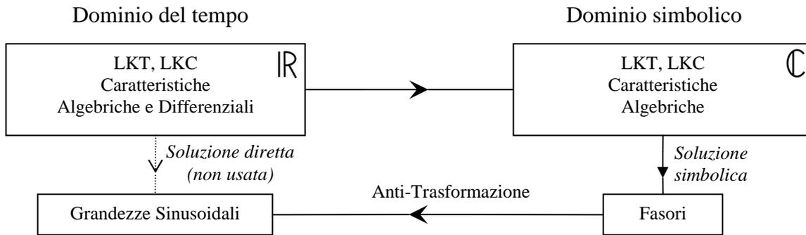
Figura 1. - Schema di risoluzione per circuiti lineari in regime AC.
