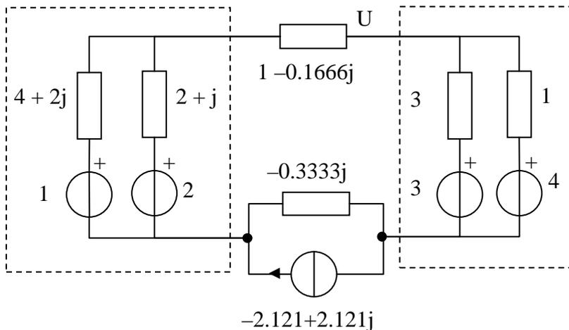
Dato che viene richiesto soltanto di determinare le potenze assorbite dal bipolo U, si potrebbe determinare l'equivalente (di Thevenin o di Norton) del bipolo collegato ad U. In questo caso però è più semplice utilizzare le equivalenze note. In particolare il bipolo di Norton in basso ed i due bipoli laterali evidenziati (che hanno la stessa struttura) si possono sostituire con i rispettivi bipoli equivalenti di Thevenin.
