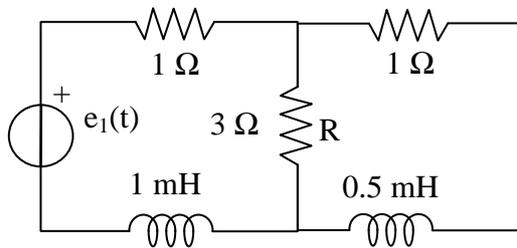
La tensione  $e_1$  è sinusoidale alla frequenza di 50 Hz e il circuito è in regime AC a 50 Hz. Le reattanze sono  $X_1 = 2\pi 50 L_1 = 314.16 \times 10^{-3} = 0.314 \Omega$  e  $X_2 = 0.157 \Omega$ . Il circuito equivalente nel dominio simbolico è quindi:
