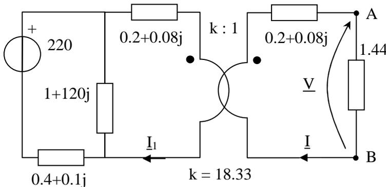
I terminali A e B sono collegati a una impedenza  $1.44 + 0j$ . Pertanto, con i versi dati,  $\underline{V} = 1.44 \underline{I}$ . Inoltre le impedenze sul secondario del trasformatore ideale sono in serie e si riportano a primario moltiplicando per il quadrato del rapporto di trasformazione ( $k$ ). Detta  $\underline{I}_1$  la corrente sul primario del trasformatore si ha quindi, con i versi scelti,  $\underline{I} = k \underline{I}_1$ .
