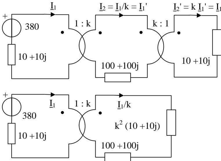
Utilizzando le caratteristiche dei due trasformatori si ha, con i versi indicati in figura per le correnti:
