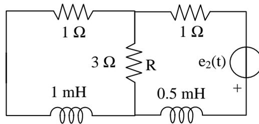
La tensione  $e_2$  è sinusoidale a frequenza 100 Hz e il circuito è in regime AC a 100 Hz. Le reattanze sono  $X_1 = 2\pi 100 L_1 = 628.32 \times 10^{-3} = 0.628 \Omega$  e  $X_2 = 0.314 \Omega$ . Il circuito equivalente nel dominio simbolico è quindi:
