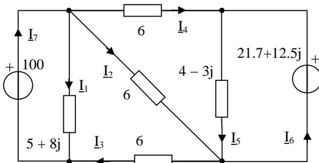
Le correnti sui rami 1 e 5 sono determinabili direttamente dalle caratteristiche, essendo le impedenze soggette alle tensioni impresse dai generatori:
