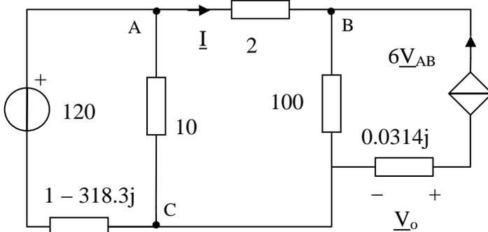
Dato che si è interessati soltanto a determinare  $\underline{V}_o$ , è possibile sostituire il parallelo tra i nodi A e C con il suo equivalente di Thevenin:
