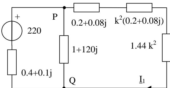
Le tre impedenze sul ramo di destra sono in serie e quindi equivalenti ad una sola impedenza di valore:
