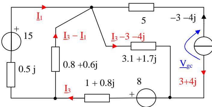
Applicando le LKC è possibile quindi dedurre le correnti su tutti i rami partendo da quelle presenti sullo schema (o definendone altre, se fosse necessario). In particolare, le LKC applicate sequenzialmente ai nodi permettono di definire le correnti su tutti i rami utilizzando  $3+4j$ ,  $\underline{I}_1$  e  $\underline{I}_3$  (correnti di maglia) e di conseguenza l'albero è costituito dai rami 2 e 4.
