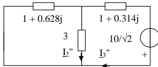
L'impedenza equivalente del parallelo è:
