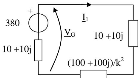
**Esercizio 14: Determinare le potenze assorbite a primario dai trasformatori e verificare il bilancio delle potenze.**
