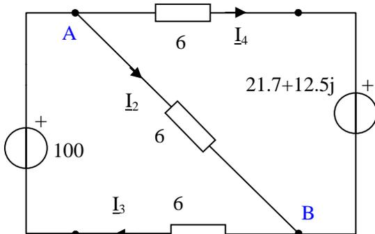
Il circuito equivalente è mostrato a lato. Considerandolo come un parallelo di tre generatori reali, la tensione sul parallelo è determinabile utilizzando il Teorema di Millman:
