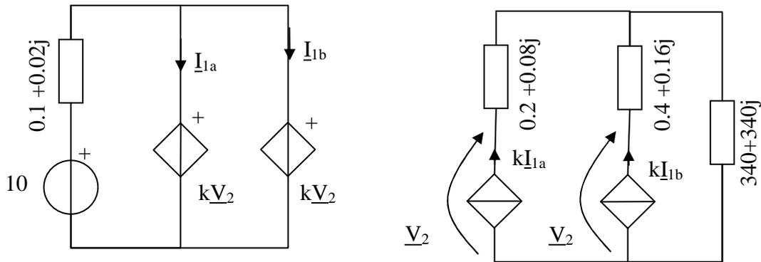
Si sono indicate le correnti sui primari come  $\underline{I}_{1a}$  ed  $\underline{I}_{1b}$ . Applicando la LKT alla maglia formata dai secondari si ha:  $0 = -\underline{V}_2 + (0.2+0.08j) \underline{I}_{1a} - (0.4+0.16j) \underline{I}_{1b} + \underline{V}_2$ . Semplificando si ha:  $\underline{I}_{1a} = 2 \underline{I}_{1b}$ . Sostituendo nel circuito ed applicando le LKC ai nodi si ottiene il seguente circuito:
