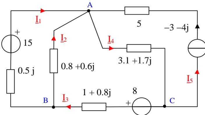
Il circuito equivalente nel dominio simbolico è rappresentato in figura (unità SI). Il circuito è costituito da  $R = 5$  rami,  $N = 3$  nodi e quindi  $R - N + 1 = 3$  maglie fondamentali. Per verificare il bilancio delle potenze è necessario calcolare le correnti su tutti i rami. Per scegliere il metodo di soluzione si noti che tutti i rami sono controllati in tensione e che tutti i rami tranne il 5 sono controllati in corrente.
