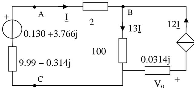
Inoltre, definendo la corrente  $\underline{I}$ , si ha  $\underline{V}_{AB} = 2\underline{I}$ , e quindi la corrente impressa dal generatore pilotato è  $6\underline{V}_{AB} = 12\underline{I}$ . Pertanto la corrente sul ramo centrale (applicando la LKC al nodo B) è  $\underline{I} + 12\underline{I} = 13\underline{I}$ . La corrente  $\underline{I}$  si determina applicando la LKT alla maglia da essa definita:
