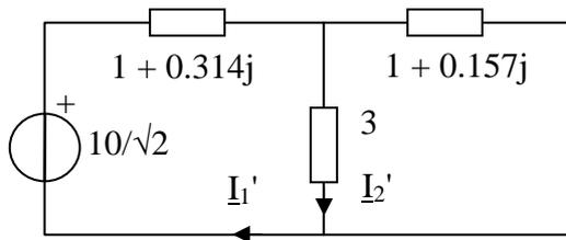
L'impedenza equivalente del parallelo è:
