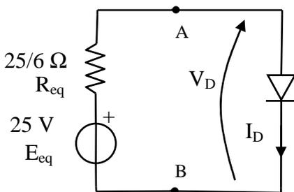
Sostituendo l'equivalente di Thevenin nel circuito iniziale si ha il circuito a sinistra, la cui soluzione è immediata se si considera che il diodo ideale, con i versi di riferimento scelti, è equivalente a:
