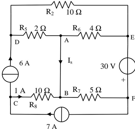
La corrente di cortocircuito (la corrente impressa dal generatore di corrente nel bipolo di Norton) è già determinabile utilizzando l'equivalenza tra le due forme del generatore reale:  $I_{eq} = E_{eq} / R_{eq} = -20/8 = -2.5 \text{ A}$ .
