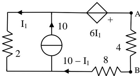
La figura a lato mostra il bipolo a vuoto. Si è utilizzata la caratteristica del resistore da  $2 \Omega$  per cambiare la variabile pilota del generatore pilotato:  $V_1 = 2 I_1$  quindi  $3V_1 = 6 I_1$ . La corrente circolante sul ramo di destra si ottiene applicando la LKC ad uno dei terminali del generatore di corrente. La corrente  $I_1$  si determina applicando la LKT alla maglia definita da  $I_1$ :  $0 = 2 I_1 - (8 + 4)(10 - I_1) + 6 I_1$ .
