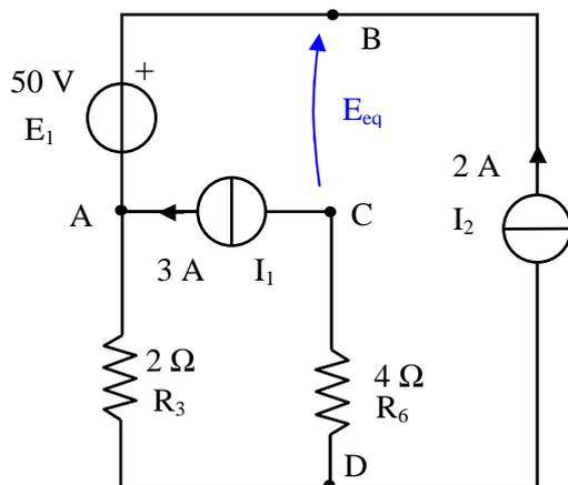
Il bipolo lineare di cui trovare l'equivalente di Thevenin è illustrato in figura. I terminali del bipolo sono B e C.
