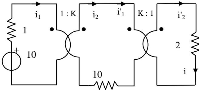
Utilizzando le caratteristiche dei due trasformatori si ha, con  $i$  versi indicati in figura per le correnti:
