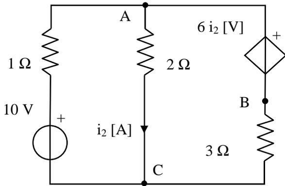
Per definizione,  $E_{eq} = V_{AB}$  a vuoto (i terminali A e B sono collegati da un circuito aperto). Si può quindi risolvere il circuito a sinistra. Applicando il teorema di Millman si ha:
