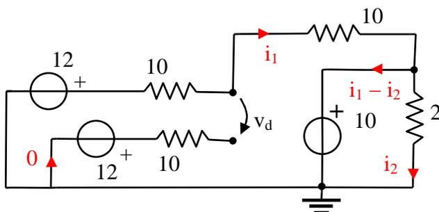
La soluzione è immediata notando che il resistore R è soggetto alla tensione di 10 V. Quindi  $i_2 = 10/2 = 5$  A e la potenza assorbita dal resistore R è data da  $P_R = R i_2^2 = 50$  W. Infine, applicando le LTK<sub>mf</sub> si ha:  $0 = -12 + 10i_1 + 10i_1 + 10$ ,  $0 = -12 + 10i_1 - v_d + 12$ . Quindi  $i_1 \cong 0.1$  A e  $v_d = 10i_1 \cong 1$  V (positiva, dunque l'A.O. è in effetti nella regione di saturazione positiva).
