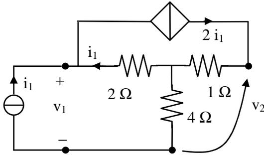
**Soluzione:** Per calcolare la prima colonna di  $[R]$ , posto  $i_2 = 0$ , il primario è alimentato con una corrente  $i_1$  arbitraria. Risolto il circuito alato per determinare  $v_1$  e  $v_2$ , si ha quindi:
