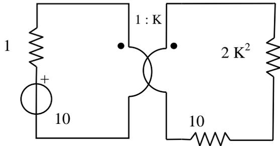
Il resistore da  $2 \Omega$ , ridotto a primario, è equivalente ad un resistore con resistenza  $2K^2$ , che si trova in serie al resistore da  $10 \Omega$ . Sommando e riducendo a primario, cioè moltiplicando per  $(1/K)^2$ , si ottiene un circuito equivalente costituito da una sola maglia su cui circola, come si è già osservato, la corrente  $i$ . Applicando la LKT a tale maglia si ottiene dunque:
