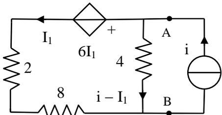
In ogni caso, per determinare la resistenza equivalente del bipolo di Thevenin, si ha  $R_{eq} = V_{AB} / i$  con i generatori indipendenti azzerati. Nel circuito a sinistra si è quindi spento il generatore indipendente e si sono collegati i terminali A e B ad un generatore di corrente esterno a corrente impressa  $i$ . La corrente circolante sul ramo centrale si ottiene applicando la LKC ad uno dei suoi terminali.
