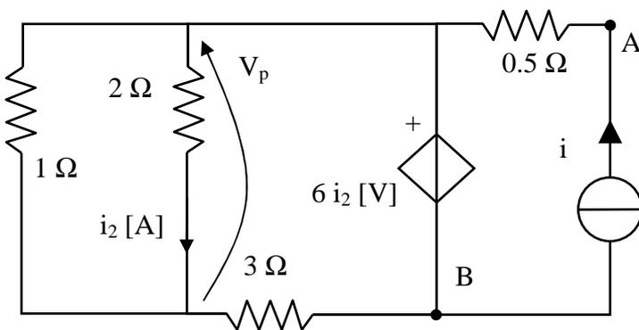
Per definizione,  $R_{eq} = V_{AB} / i$  con i generatori indipendenti azzerati (dove i è la corrente circolante nel bipolo con il verso di riferimento associato alla tensione  $V_{AB}$ , e dunque entrante in A ed uscente da B). Nel circuito a sinistra si è quindi spento il generatore indipendente e si sono collegati i terminali A e B ad un generatore di corrente esterno a corrente impressa i.
