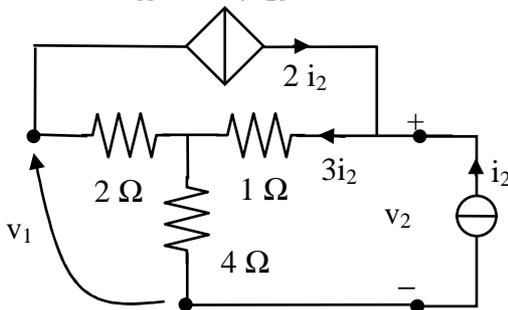
Per calcolare la seconda colonna di  $[R]$ , posto  $i_1 = 0$ , il secondario è alimentato con una corrente  $i_2$  arbitraria. Risolto il circuito per determinare  $v_1$  e  $v_2$ , si ha quindi:
