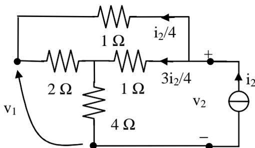
2) posto  $i_1 = 0$ , il secondario è alimentato con una corrente  $i_2$  arbitraria. Risolto il circuito per determinare  $v_1$  e  $v_2$ , si ha quindi:
