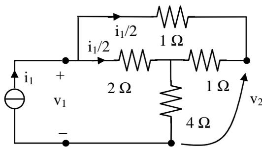
1) Posto  $i_2 = 0$ , il primario è alimentato con una corrente  $i_1$  arbitraria. Risolto il circuito per determinare  $v_1$  e  $v_2$ , si ha quindi:
