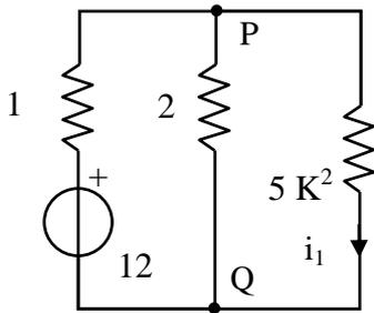
Per determinare  $i_1$  è sufficiente conoscere la tensione  $V_{PQ}$ , infatti  $i_1 = V_{PQ} / (5K^2)$ . Per determinare la tensione  $V_{PQ}$  è possibile utilizzare il Teorema di Millman, da cui:
