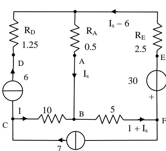
Si può trasformare il triangolo di resistori collegati ai terminali D, A e E. Le resistenze equivalenti sono date da:
