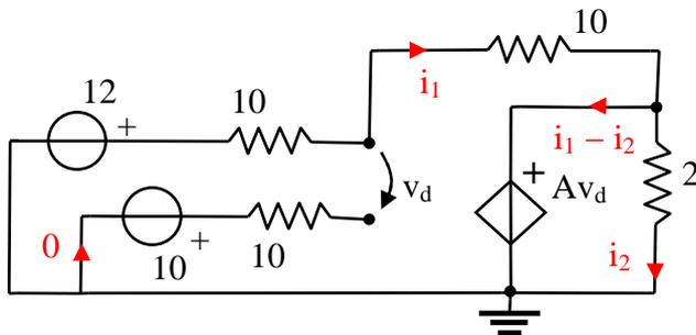
Il circuito è costituito quindi da due maglie (la corrente sul generatore di tensione da 10 V è nulla, essendo collegato ad un terminale isolato). Definendo quindi le correnti  $i_1$  ed  $i_2$ , la corrente sul ramo centrale si ottiene applicando la LKC ad uno dei suoi terminali. Applicando le LTK<sub>mf</sub> (le maglie fondamentali sono definite dalle correnti  $i_1$  ed  $i_2$ ) si ha:
