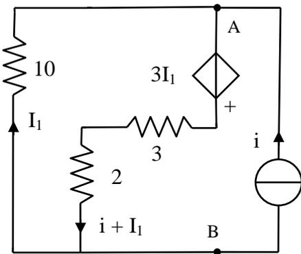
Nel circuito a sinistra si è quindi spento il generatore indipendente e si sono collegati i terminali A e B ad un generatore di corrente esterno a corrente impressa i. La corrente sul ramo contenente il generatore pilotato si deduce applicando la LKC al nodo A. Applicando la LKT alle due maglie del circuito si ha quindi:
