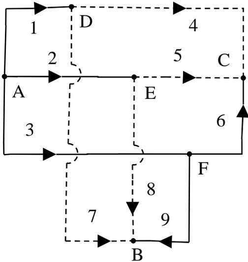
L'albero  $\{1, 2, 3, 6, 9\}$ , costituito da  $N-1 = 5$  rami, è indicato in figura con le linee continue. Il Coalbero  $\{4, 5, 7, 8\}$ , costituito da  $R-N+1 = 4$  rami, è indicato in figura con le linee tratteggiate. La matrice delle maglie fondamentali  $[B]$  si ottiene applicando le LKT a tutte le maglie fondamentali. Le maglie fondamentali, individuate aggiungendo un ramo di coalbero alla volta all'albero, sono  $R-N+1 = 4$ , e in particolare:
