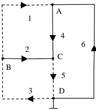
L'albero {2, 4, 6}, costituito da  $N-1 = 3$  rami, è indicato in figura con le linee continue. Il Coalbero {1, 3, 5}, costituito da  $R-N+1 = 3$  rami, è indicato in figura con le linee tratteggiate. La matrice delle maglie fondamentali [B] si ottiene applicando le LKT a tutte le maglie fondamentali. Le maglie fondamentali, individuate aggiungendo un ramo di coalbero alla volta all'albero, sono  $R-N+1 = 3$ , e in particolare:
