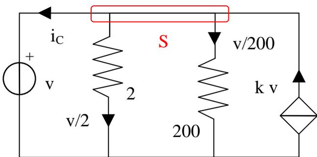
Pertanto, nel circuito (unità SI) si è rappresentato il condensatore tramite un generatore indipendente di tensione a tensione impressa  $v$  (coincidente con la variabile pilota del generatore pilotato) e si è spento il generatore di corrente indipendente. Applicando la LKC alla superficie chiusa  $S$  si ha:  $0 = -kv + v/2 + v/200 + i_C$ .
