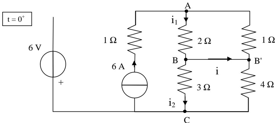
Il generatore di tensione è percorso da corrente nulla (è in serie ad un circuito aperto), quindi è equivalente ad un circuito aperto. Indicando con A, B, B' e C i quattro nodi nel circuito si nota che la coppia di resistori da 1 Ω e 2 Ω è in parallelo. Analogamente la coppia di resistori da 3 Ω e 4 Ω è in parallelo. Le rispettive resistenze equivalenti sono quindi  $\frac{2}{3} \Omega$  e  $\frac{12}{7} \Omega$ . Il circuito equivalente è quindi il seguente:
