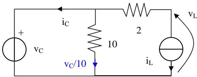
La corrente sul ramo centrale si deduce notando che il resistore da  $10 \Omega$  è soggetto alla tensione  $v_C$ . Applicando la LKC ad uno dei suoi terminali si ha:  $i_C + i_L + v_C/10 = 0$  e quindi
