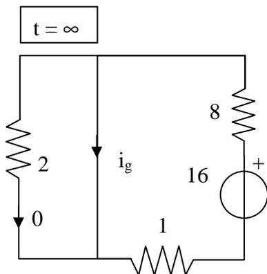
**Soluzione:** Si consideri il circuito un istante prima dell'apertura dell'interruttore ( $t = 0^-$ ) al fine di determinare la corrente sul generatore e le variabili di stato dei componenti con memoria. Il circuito è in regime DC; pertanto, induttori ed condensatori sono equivalenti a cortocircuiti e circuiti aperti, rispettivamente. Inoltre l'interruttore è chiuso, quindi è equivalente ad un cortocircuito.
