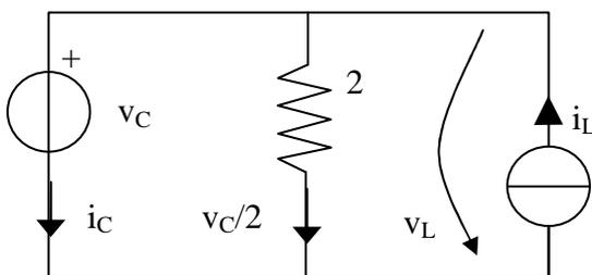
È quindi necessario determinare la tensione sull'induttore e la corrente sul condensatore considerando note le variabili di stato. Pertanto, nel circuito (unità SI) si sono rappresentati i componenti con memoria tramite generatori indipendenti.
