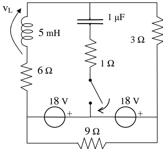
**Esercizio 1.** Calcolare la tensione  $v_L$  un istante dopo la chiusura dell'interruttore T ( $t=0$ ). Si supponga che il circuito sia in regime stazionario prima della chiusura dell'interruttore e che il condensatore sia scarico.
