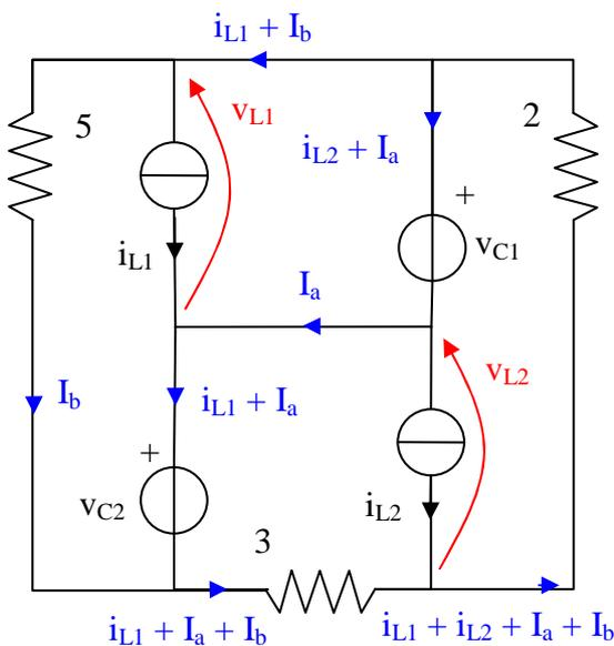
Il circuito equivalente è mostrato a lato.. Le correnti su tutti i rami del circuito sono determinate applicando la LKC a tutti i nodi (oltre alle correnti sugli induttori è necessario introdurre altre due correnti  $I_a$  ed  $I_b$ , come mostrato). Le quattro maglie fondamentali sono definite da  $i_{L1}$ ,  $i_{L2}$ ,  $I_a$  ed  $I_b$ . Applicando le LKT<sub>mf</sub> si ha:
