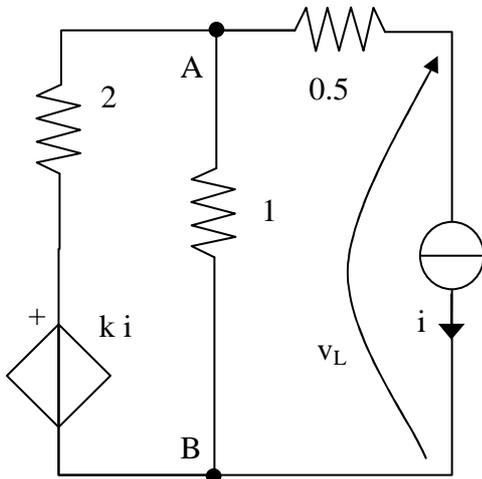
Pertanto, nel circuito (unità SI) si è rappresentato l'induttore tramite un generatore indipendente di corrente a corrente impressa  $i$  e si è spento il generatore di tensione indipendente. Applicando la LKT alla maglia di destra si ha:  $0 = -v_{AB} + 0.5i + v_L$ .
