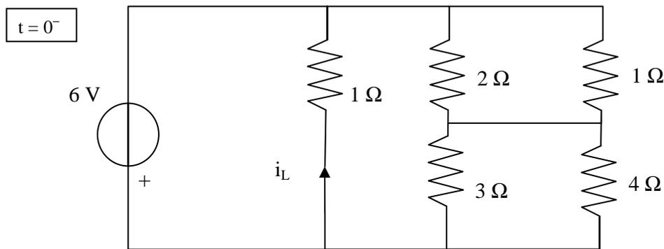
All'istante  $t = 0^+$  l'interruttore è aperto e la corrente sull'induttore nota: per il postulato di continuità dell'energia  $i_L(0^+) = i_L(0^-) = 6 \text{ A}$ . L'induttore quindi è equivalente (solo per  $t = 0^+$ ) ad un generatore indipendente di corrente con corrente impressa 6 A.
