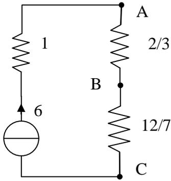
Le tensioni  $V_{AB}$  e  $V_{BC}$  sono immediatamente calcolabili tramite le caratteristiche dei resistori:
