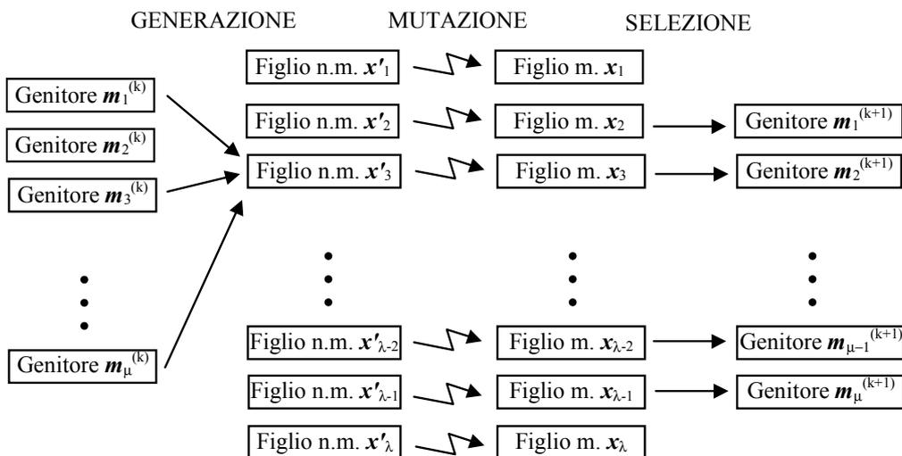
*Fig.1 – Schema di principio del metodo GES.*
