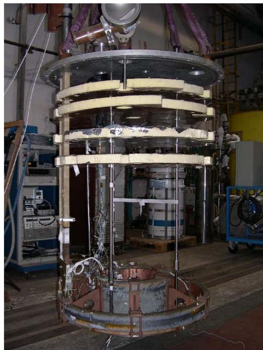
Figura 1. Predisposizione del  $\mu$ SMES per l'alloggiamento nel criostato.
