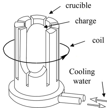
Fig. 1. - Cold crucible scheme.
