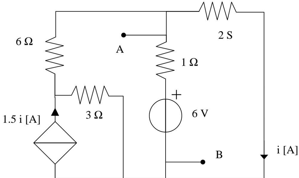
Il circuito è in regime in regime sinusoidale a frequenza 50 Hz. Calcolare:
