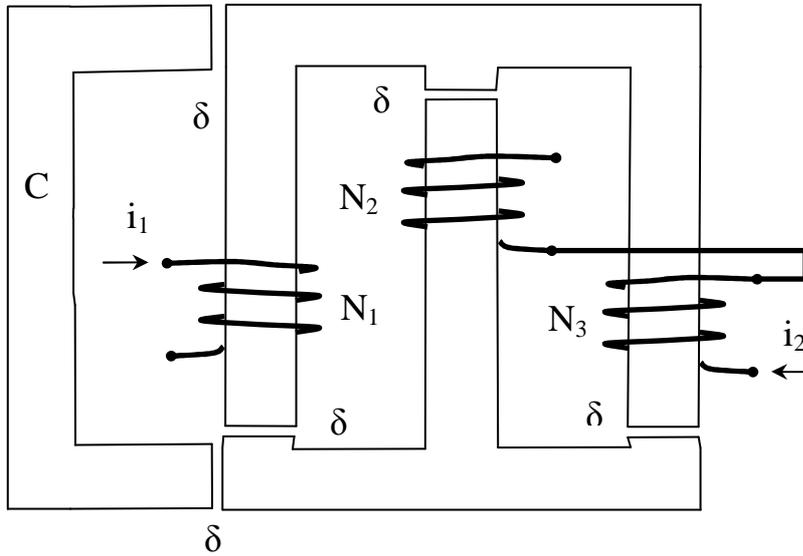
Un carico trifase  $U_1$ , collegato ad una linea trifase che rende disponibile una terna di tensioni concatenate simmetrica e diretta (frequenza 50 Hz, valore efficace 400 V), è costituito da tre impedenze uguali collegate a stella. Ciascuna impedenza del carico è costituita come in figura. Calcolare:
