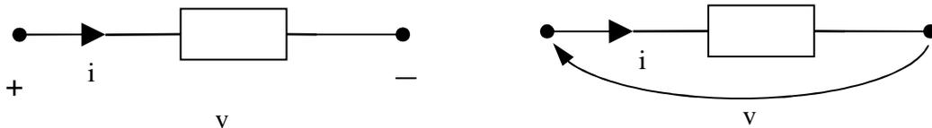
Figura 6.a Versi di riferimento associati (secondo la scelta dell'utilizzatore) per la tensione e la corrente di ramo. A destra, l'indicazione del “-” e del “+” è sostituita da una freccia che indica il terminale positivo.
