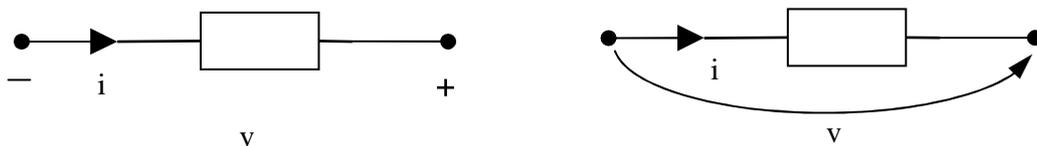
Figura 6.b Versi di riferimento associati (secondo la scelta del generatore) per la tensione e la corrente di ramo. A destra, l'indicazione del “-” e del “+” è sostituita da una freccia che indica il terminale positivo.
