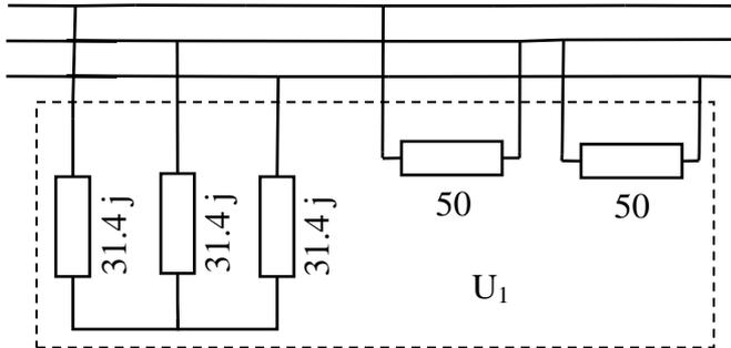
Il carico  $U_1$  quindi è costituito da due resistori soggetti a tensioni concatenate (400 V) ed una stella equilibrata (3 reattanze uguali,  $\omega L = 31.4 \Omega$ , soggette alle tensioni principali di fase  $400/\sqrt{3} = 230 \text{ V}$ ) Grazie all'additività delle potenze in AC, la potenza complessa assorbita da  $U_1$  è pari a:
