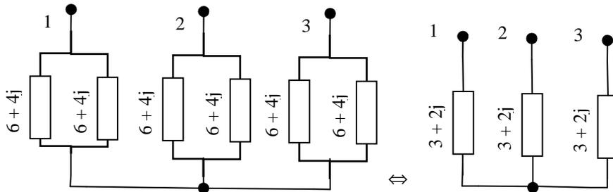
**Esercizio 6:** Calcolare i valori efficaci delle correnti su ogni fase del carico di figura, le potenze attiva e reattiva assorbite ed il fattore di potenza. La rete trifase con neutro (in AC) è simmetrica diretta con un valore efficace della tensione concatenata pari a 380 V alla frequenza di 50 Hz.
