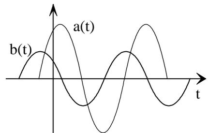
Figura 2.c -  $a(t)$  e  $b(t)$  sono in quadratura.
