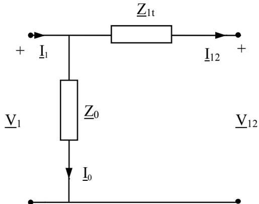
Figura 10. - circuito equivalente semplificato del trasformatore ridotto a primario.
