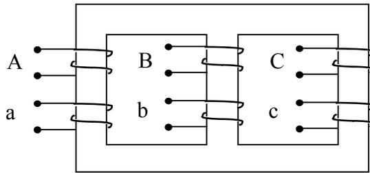
Figura 8.4. - Trasformatore trifase con nucleo complanare.
