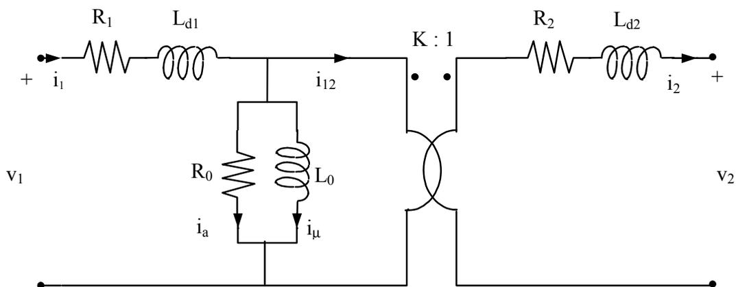
Figura 7. - Circuito equivalente del trasformatore reale.
