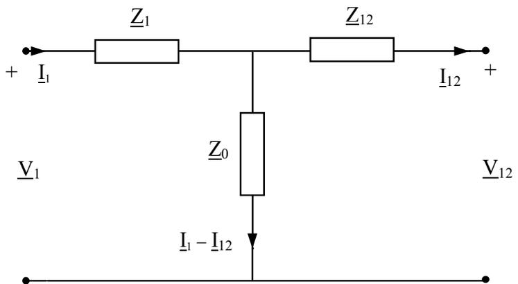
Figura 9. - circuito equivalente del trasformatore ridotto a primario.
