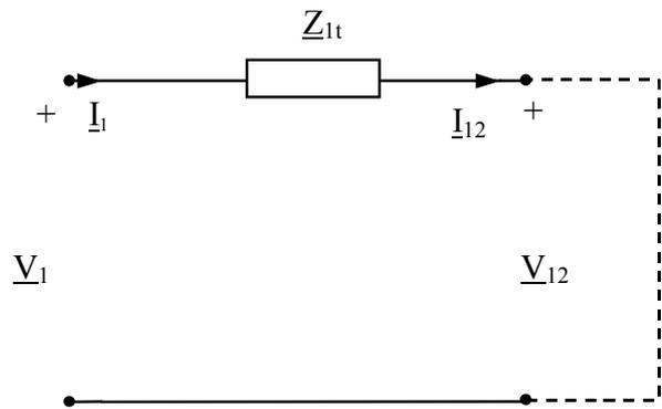
Figura 11. - Circuito equivalente semplificato del trasformatore, valido nel funzionamento in cortocircuito (rete di Kapp)
