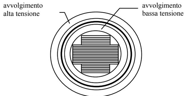
Figura 1.4 - sezione di una colonna del nucleo magnetico
