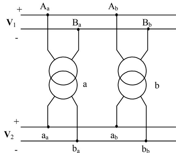
Figura 9.1. - Parallelo di due trasformatori
