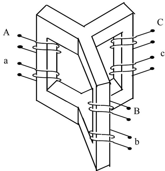
Figura 8.3. - Trasformatore trifase con nucleo simmetrico.
