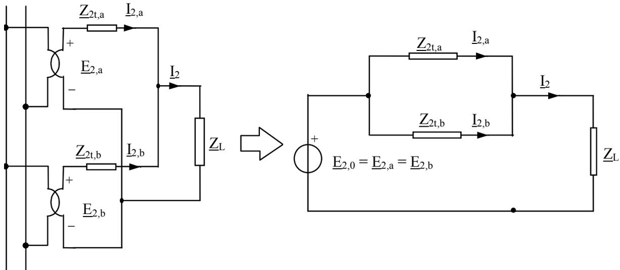
Figura 9.2. - Circuito equivalente riferito al secondario del parallelo di due trasformatori
