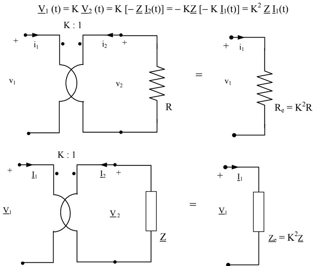
Figura 3 - Riduzione da secondario a primario.
