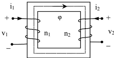
Figura 1.1.a - Schema di principio di un trasformatore monofase.
