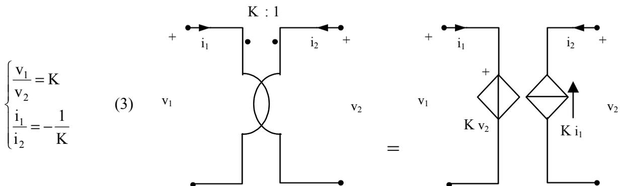
Figura 2 - Trasformatore ideale e circuito equivalente.
