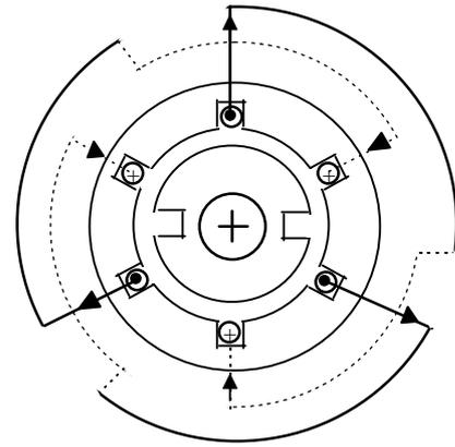
Schema di principio della sezione mediana di una macchina elettrica a traferro costante
