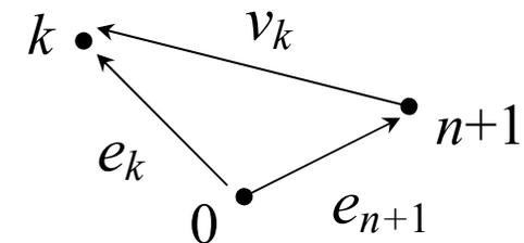
In particolare, è possibile assumere come riferimento uno degli  $n+1$  morsetti del multipolo, riducendo la sommatoria ad  $n$  termini ed utilizzando utilizzando le tensioni e le correnti precedentemente definite:
