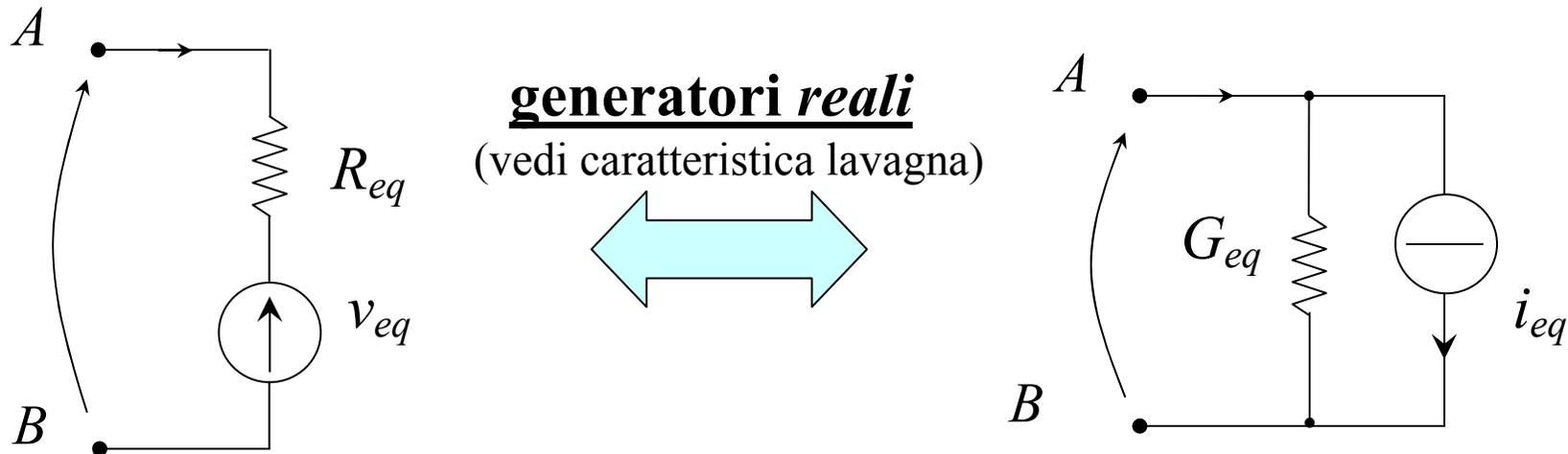
Nota: Nel caso in cui siano presenti generatori pilotati esternamente, è necessario aggiungere un generatore pilotato equivalente serie di tensione (Thévenin) o un generatore pilotato equivalente parallelo di corrente (Norton). Tali generatori rappresentano, rispettivamente, la tensione a vuoto o la corrente di corto con i generatori indipendenti disattivati.
