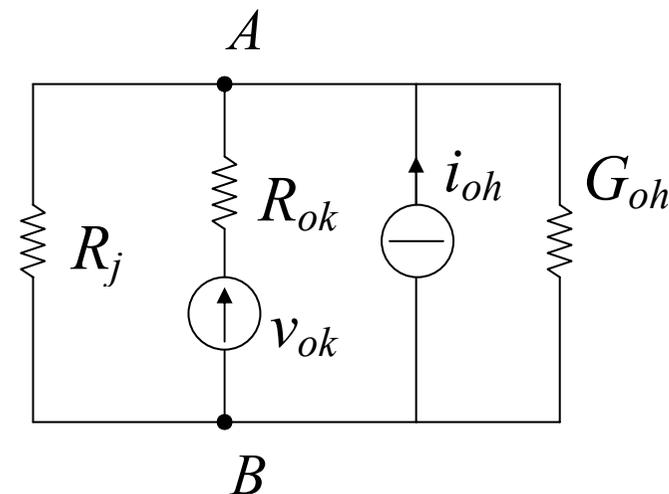
**Nota:** *in presenza di soli generatori di tensione reali, la tensione risultante è la media pesata delle loro tensioni, essendo il peso costituito dalle rispettive conduttanze.*
