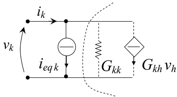
$$i_k = G_{kk} v_k + \sum_{\substack{h=1 \\ h \neq k}}^n G_{kh} v_h + i_{eqk}$$
