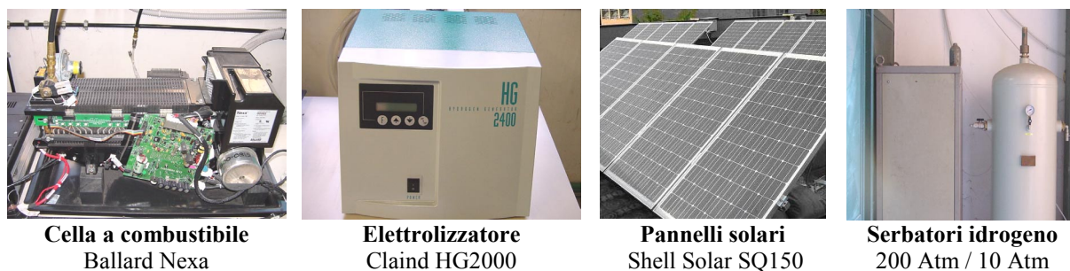
Fig. 2. Immagini dei principali elementi della realizzazione sperimentale.
