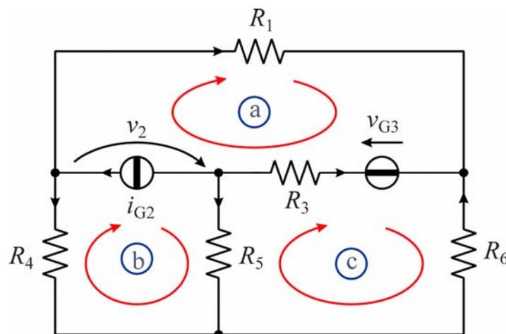
**Anello a:**  $(R_1 + R_3)i_a - R_3i_c + v_2 = v_{G3}$
