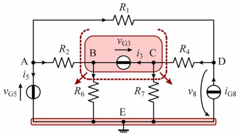
**Supernodo B-C:**  $(G_2 + G_6)v_B + (G_4 + G_7)v_C - G_4v_D = G_2v_{G5}$
