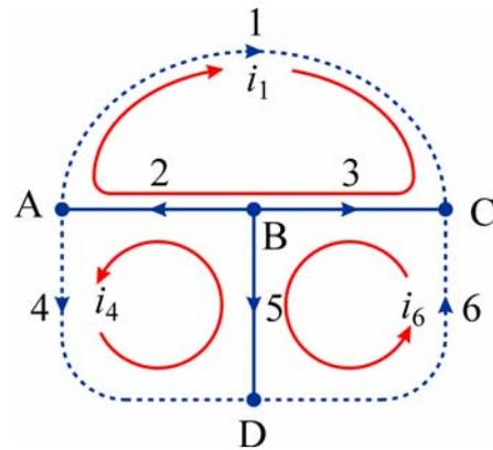
**Maglia 1:**  $(R_1 + R_3)i_1 + R_3i_6 + v_2 = v_{G3}$
