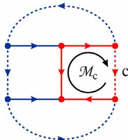
*La maglia viene orientata in senso concorde con il lato caratteristico*
