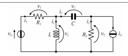
Si vogliono scrivere le equazioni di stato del circuito e le equazioni di uscita relative alle risposte  $v_1(t)$  e  $i_2(t)$
