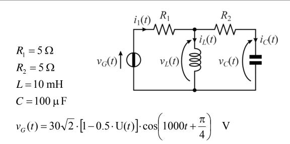
Per t<0 il circuito è in condizioni di regime sinusoidale Determinare i valori per  $t=0^+$  di  $i_L$ ,  $v_C$ ,  $i_1$  e delle loro derivate
