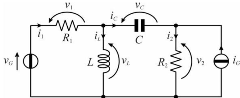
Si vogliono scrivere le equazioni di stato del circuito e le equazioni di uscita relative alle risposte  $v_1(t)$  e  $i_2(t)$
