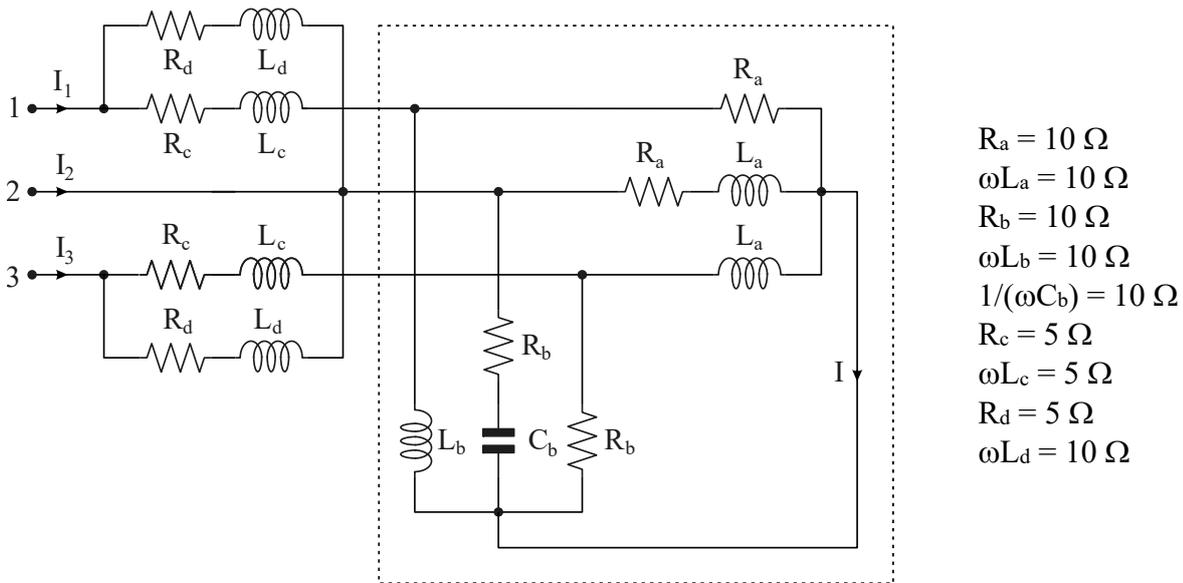
Il sistema trifase rappresentato in figura è alimentato da una terna simmetrica diretta di tensioni concatenate di valore efficace 400V. Assumendo nulla la fase di  $V_{23}$ , determinare:
