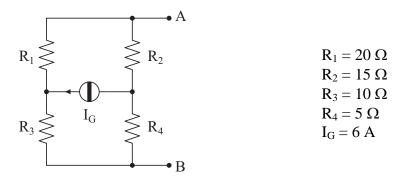
Determinare i parametri dei bipoli equivalenti di Thévenin e Norton del bipolo A-B.
