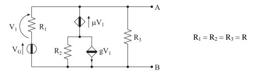
Noti R, μ, g, e V<sub>G</sub>, determinare i parametri dei bipoli equivalenti di Thévenin e Norton del bipolo A-B.
