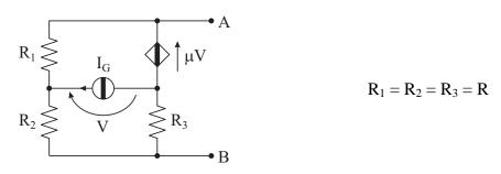
Noti R, μ, e I<sub>G</sub>, determinare i parametri dei bipoli equivalenti di Thévenin e Norton del bipolo A-B.
