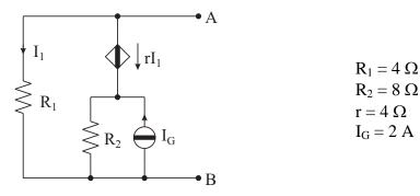
Determinare i parametri dei bipoli equivalenti di Thévenin e Norton del bipolo A-B.
