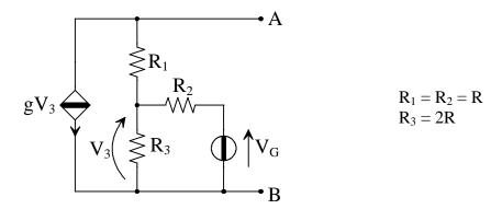
Noti R, g e V<sub>G</sub>, determinare i parametri dei bipoli equivalenti di Thévenin e Norton del bipolo A-B.
