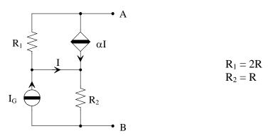
Noti R, α e I<sub>G</sub>, determinare i parametri dei bipoli equivalenti di Thévenin e Norton del bipolo A-B.
