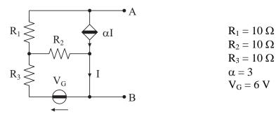
Determinare i parametri dei bipoli equivalenti di Thévenin e Norton del bipolo A-B.
