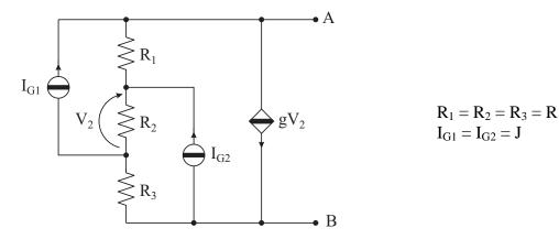
Noti R, g e J, determinare i parametri dei bipoli equivalenti di Thévenin e Norton del bipolo A-B.
