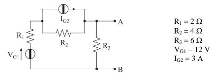
Determinare i parametri dei bipoli equivalenti di Thévenin e Norton del bipolo A-B.
