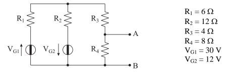
Determinare i parametri dei bipoli equivalenti di Thévenin e Norton del bipolo A-B.
