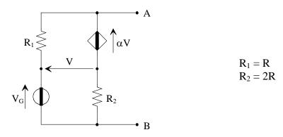
Noti R,  $\alpha$  e  $V_G$ , determinare i parametri dei bipoli equivalenti di Thévenin e Norton del bipolo A-B.
