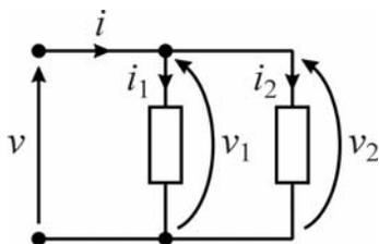
**LKV**  $v = v_1 = v_2$
