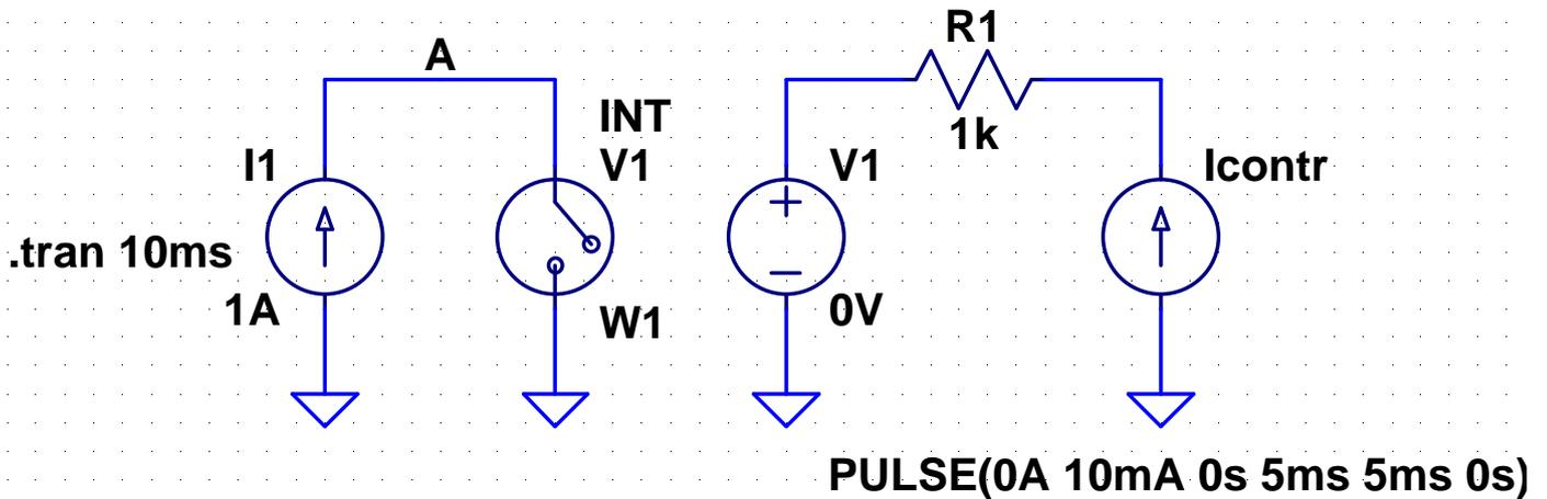
Si usa un generatore di tensione nulla per rendere disponibile la corrente di controllo.
