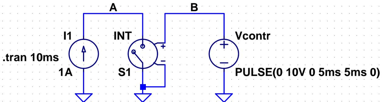
Scambiando i valori di  $R_{on}$  e  $R_{off}$  si può fare in modo che l'interruttore sia chiuso quando la tensione è minore di
