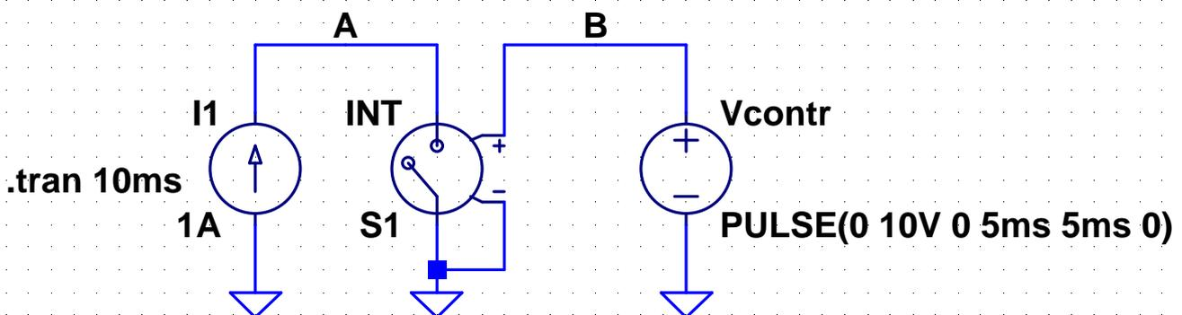
Il generatore di corrente I1 viene usato per misurare la resistenza dell'interruttore.
