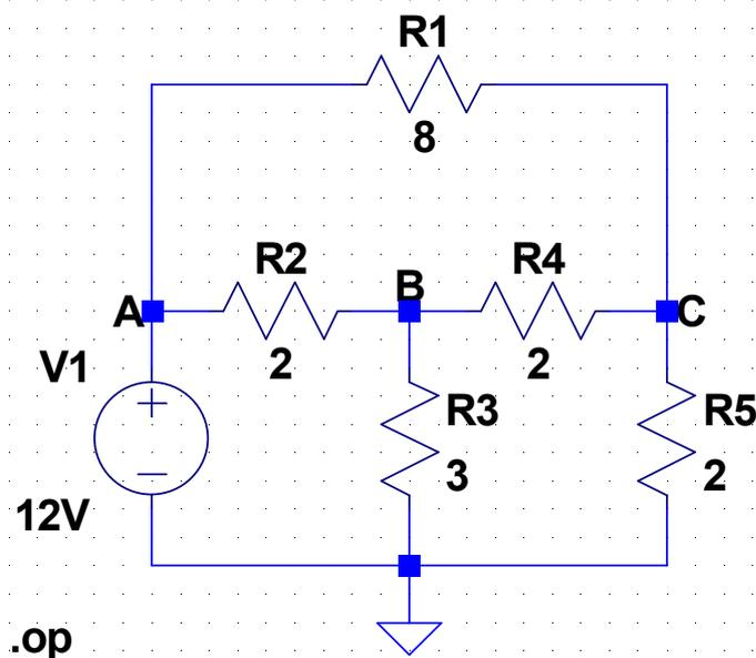
La simulazione produce una tabella con i valori delle tensioni di nodo e delle correnti dei componenti. Posizionando il cursore su un nodo è possibile leggere il valore della tensione nella barra di stato. Posizionando il cursore su un componente è possibile vedere nella barra di stato la sua corrente e la potenza assorbita (dissipation).
