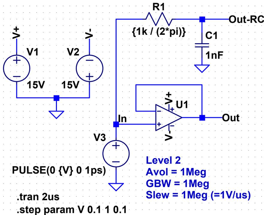
Se si prova ad assegnare un valore molto grande (per es. 100Meg) a Slew le risposte dei due circuiti si sovrappongono
