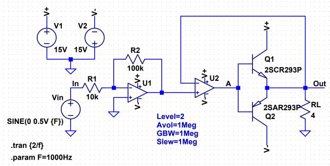
E' possibile aumentare la massima frequenza per cui non si ha distorsione riducendo il guadagno di anello.
