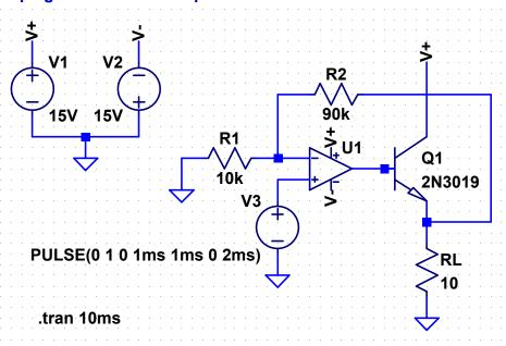
Il transistor è collegato a collettore comune (elevato guadagno di corente e elevata resistenza di ingresso). Inserendo il transistor nell'anello di retroazione si evita la caduta di tensione dovuta alla giunzione BE (la tensione dell'emettitore è fissata dall'operazionale) Il circuito può fornire solo correnti positive.
