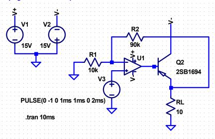
Utilizzando un transistor PNP si ottiene un circuito in grado di fornire in uscita solo correnti negative.
