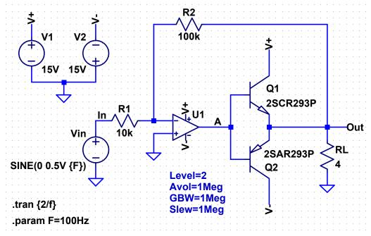
Il circuito è in grado di fornire al carico correnti positive e negative
