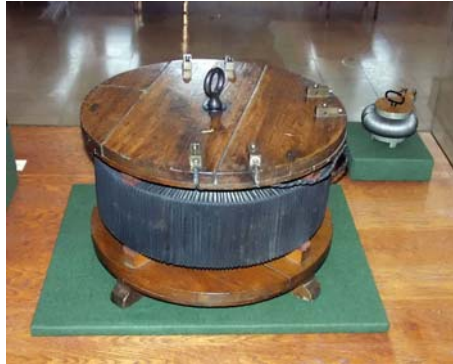
Source: Die ersten Transformatoren (Déri-Bláthy-Zipernowsky, Budapest, 1885.) Schloss Széchenyi in Nagycenk
