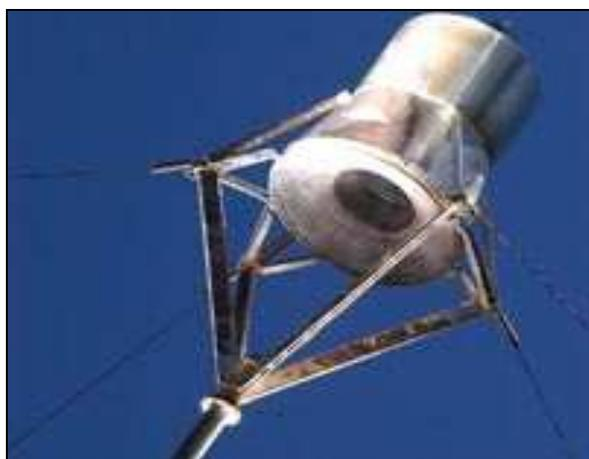
**Figura 77:** Parabolic dish, foto del motore stirling SPB Solo V-160 e V-161 [13].
