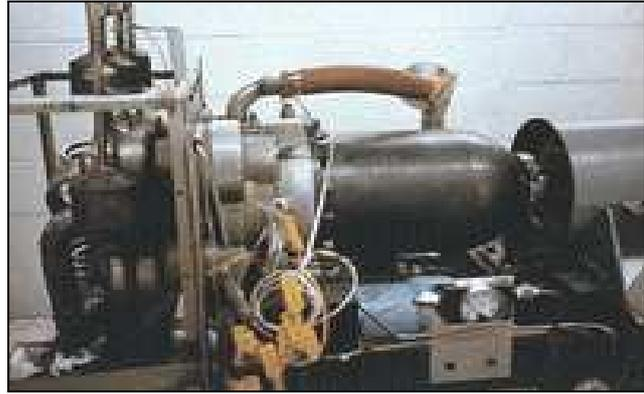
**Figura 75:** Parabolic dish, foto del motore stirling USAB 4-95 MKII [13].
