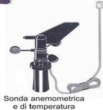
Sonda anemometrica e di temperatura
