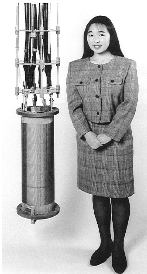
Fig. 24 Avvolgimento di un limitatore di corrente
